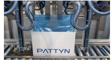
Die Seitenfalteinrichtung faltet den Beutel
