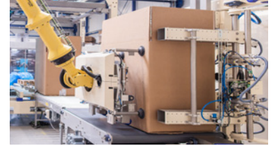
Estructura para apertura de cajas
