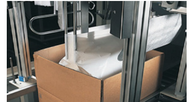
Die Seitenfalteinrichtung faltet den Beutel
