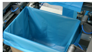
Dépose de saches contrôlée
