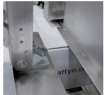
Pliage des rabats longs à entraînement pneumatique
