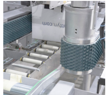
Courroies latérales robustes, entraînées par 2 moteurs
