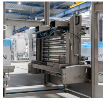
Cinta de alimentación abatible para facilitar la limpieza
