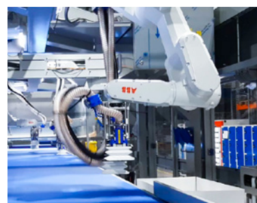
Robot montado en el techo
