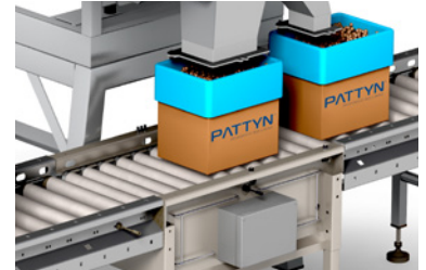
Remplissage fin dans trémie peseuse séparée pour des projections minimales
