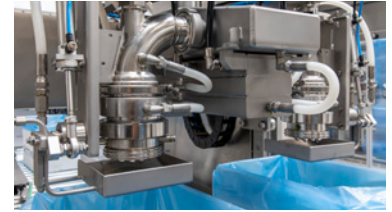
Vanne coudée à 90° avec attrape gouttes
