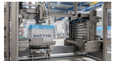
Convoyeur d'alimentation incliné pour un nettoyage facile
