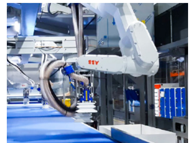
Robot montado en el techo
