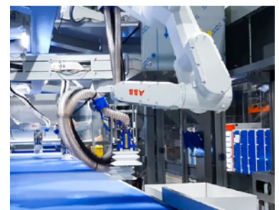
An der Decke montierter Roboter
