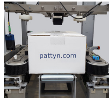
Courroies latérales robustes, entraînées par 2 moteurs
