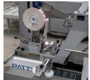
Système rapide et très maniable de remplacement de la tête de scotchage
