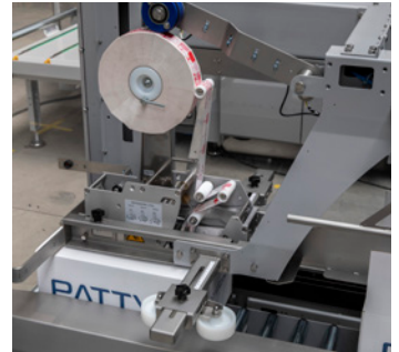
Sistema de fácil extracción del cabezal de cinta superior
