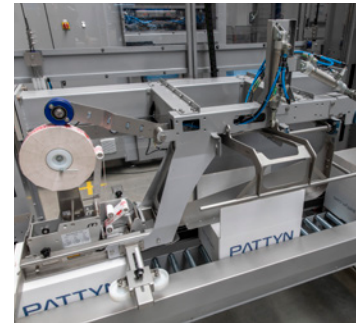
Pneumatische Umlegung der langen Laschen
