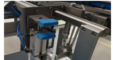
Nuevo y resistente módulo de cuchara y pinza
