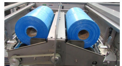
Cambio de bobina automático (opcional)
