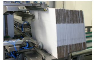
Système sécurisé de prise de cartons
