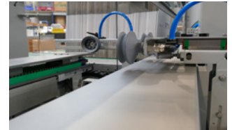
Der Karton wird an 3 Seiten gesichert
