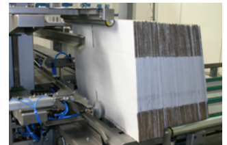
Funktionssichere Vereinzelnung der Kartonzuschnitte
