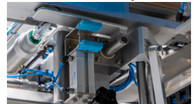
Robuste Folienabstreifer & mechanische Greifer
