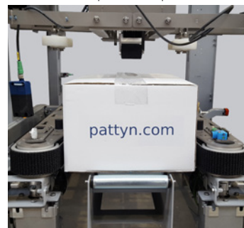
Courroies latérales robustes, entraînées par 2 moteurs
