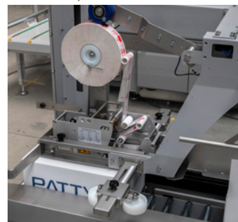
Système rapide et très maniable de remplacement de la tête de scotchage
