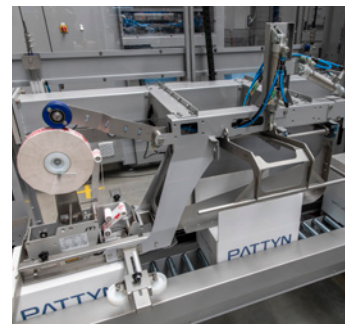
Pliage des rabats longs à entraînement pneumatique
