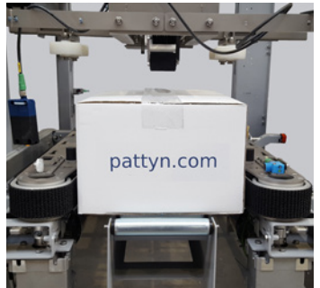
Cintas laterales robustas, accionadas por 2 motores
