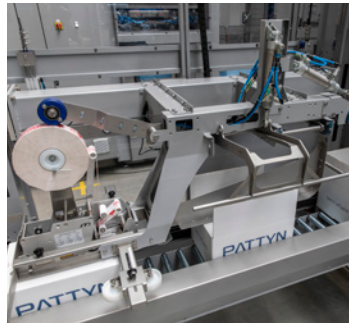
Plegado neumático para el plegado de las solapas largas
