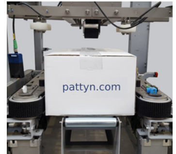
Robuste Seitenbänder, durch 2 Motoren angetrieben
