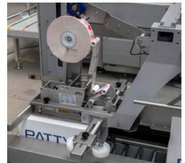
Einfache Klebebandbeladung für oberen Klebekopf
