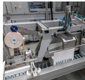
Pliage des rabats longs à entraînement pneumatique
