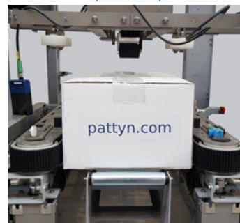
Courroies latérales robustes, entraînées par 2 moteurs
