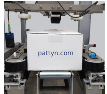
Robuste Seitenbänder, durch 2 Motoren angetrieben
