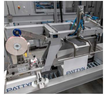
Pneumatische Umlegung der langen Laschen
