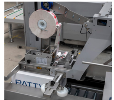
Einfache Klebebandbeladung für oberen Klebekopf
