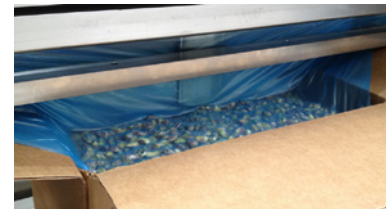
Mise sous vide et injection de gaz neutre
