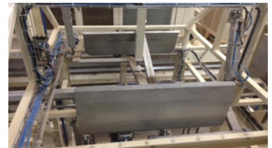
Pliage en soufflets avant la soudure
