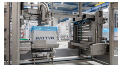
Kippbares Einlaufrollenbahn für einfache Reinigung
