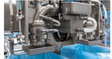
90° abgewinkeltes Füllventil mit Tropfenauffangblech
