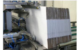
Funktionssichere Vereinzelnung der Kartonzuschnitte
